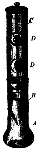
Analytischer Extractions-Apparat von Dr. Thorn.
